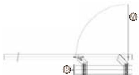
Die Elemente werden gegenüber der Hauptlaufschiene im rechten Winkel zusammengeschoben und verstaut.
