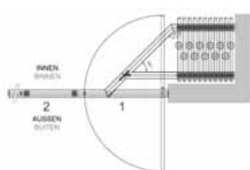
Hinter einer Wand verstaut Elemente. Das erste Element ist eine auf einer Bremse oder einer freien Achse montierte festinstallierte Tür.
